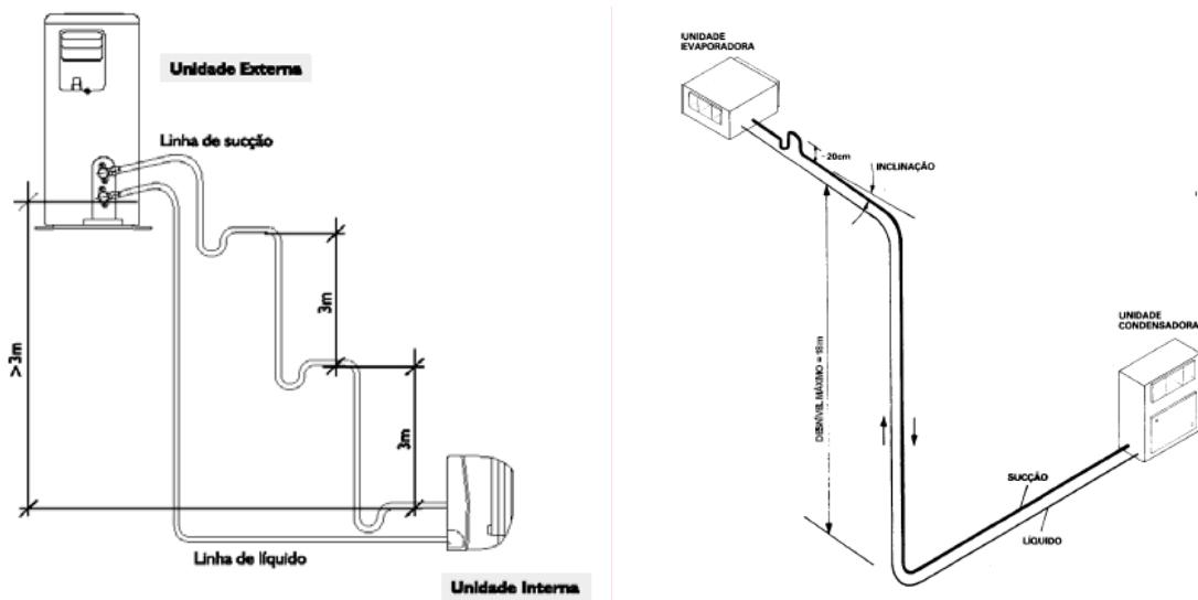
1.2.6.10. Todas as dobras na tubulação de cobre deverão ser feitas com o auxílio de ferramenta adequada (mola de dobramento), para evitar estrangulamento dos tubos. Em hipótese alguma poderão ser feitas curvas nos tubos com as mãos.
